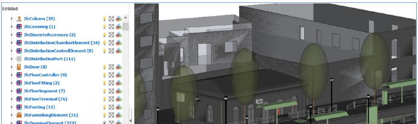
**Tabla 11** Ejemplo de listado de tipos IFC (`IfcColumn`, `IfcCovering`, etc.) de un modelo de estación ferroviaria y su entorno
