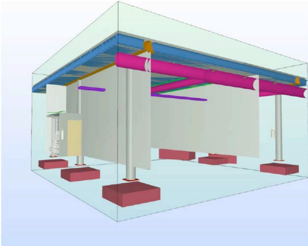
Figura 6. Detección de deficiencias que muestra que las columnas no están conectadas a los elementos de cimentación.
